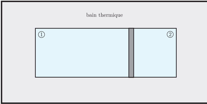
Fig. 4.2 Un système fermé et rigide contenant un gaz homogène est divisé en deux parties séparées par une paroi mobile, imperméable et diatherme. Le système est en contact avec un bain thermique à température T constante.
